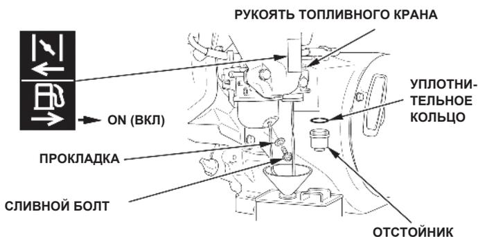
4. После того, как всё топливо стечёт в канистру, установите на место сливной болт, прокладку, отстойник топлива и уплотнительное кольцо. Надёжно затяните сливной винт и отстойник топлива.
