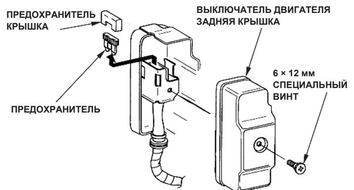
Частые выходы из строя предохранителя как правило являются признаком короткого замыкания или перегрузки электрической цепи. Если предохранитель перегорает часто, отвезите двигатель к официальному дилеру Honda для проведения ремонта.
