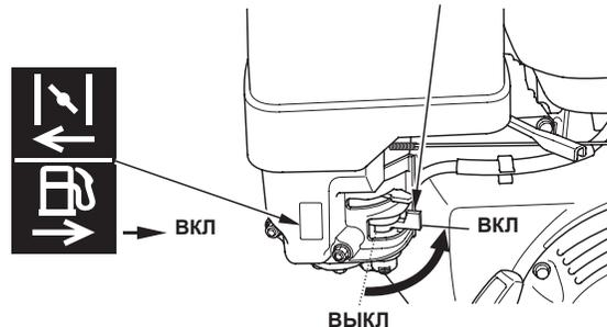
2. Для запуска холодного двигателя передвиньте рычаг воздушной заслонки или ручку воздушной заслонки (если имеется) в положение CLOSED - ЗАКРЫТО.
