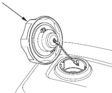
2. Доливайте топливо до нижней части предельного уровня в топливном баке. Не переливайте выше уровня. Вытрите пролитое топливо, прежде, чем запустить двигатель.
