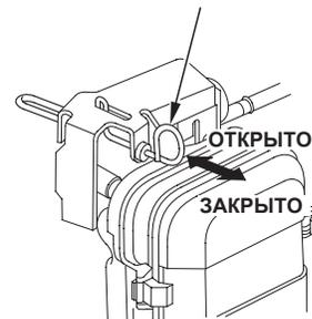
Для повторного запуска горячего двигателя оставьте рычаг воздушной заслонки или ручку воздушной заслонки в положении OPEN - ОТКРЫТО.
