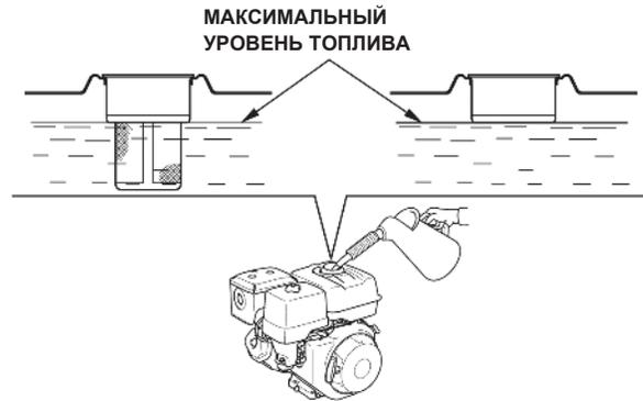
3. Доливайте осторожно, избегая пролива топлива. Не заполняйте топливный бак до краёв. В зависимости от условий эксплуатации требуемый уровень топлива может быть более низким. После дозаправки плотно и надёжно закройте пробку топливозаливной горловины.
