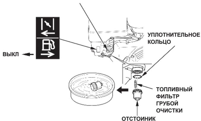
3. Установите уплотнительное кольцо на топливный кран и установите отстойник топлива. Надёжно закрепите отстойник топлива.
